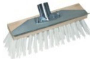
Monture bois. Fibres synthétiques (résistance 130°C). Grattoir tôle galvanisée pour gratter enrobés et gravillons. Douille métal 28 mm. Boulons traversants. Manche vendu séparément
